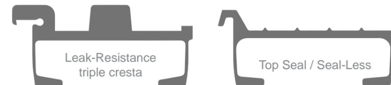
Solapamiento crea 3<sup>rd</sup> cresta, la carga presiona el sello creando un cierre resistente a las fugas
