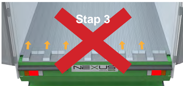
ACCELERATOR ingeschakeld Stap 3. (3/3) Vloerprofielen Schuiven NIET in
